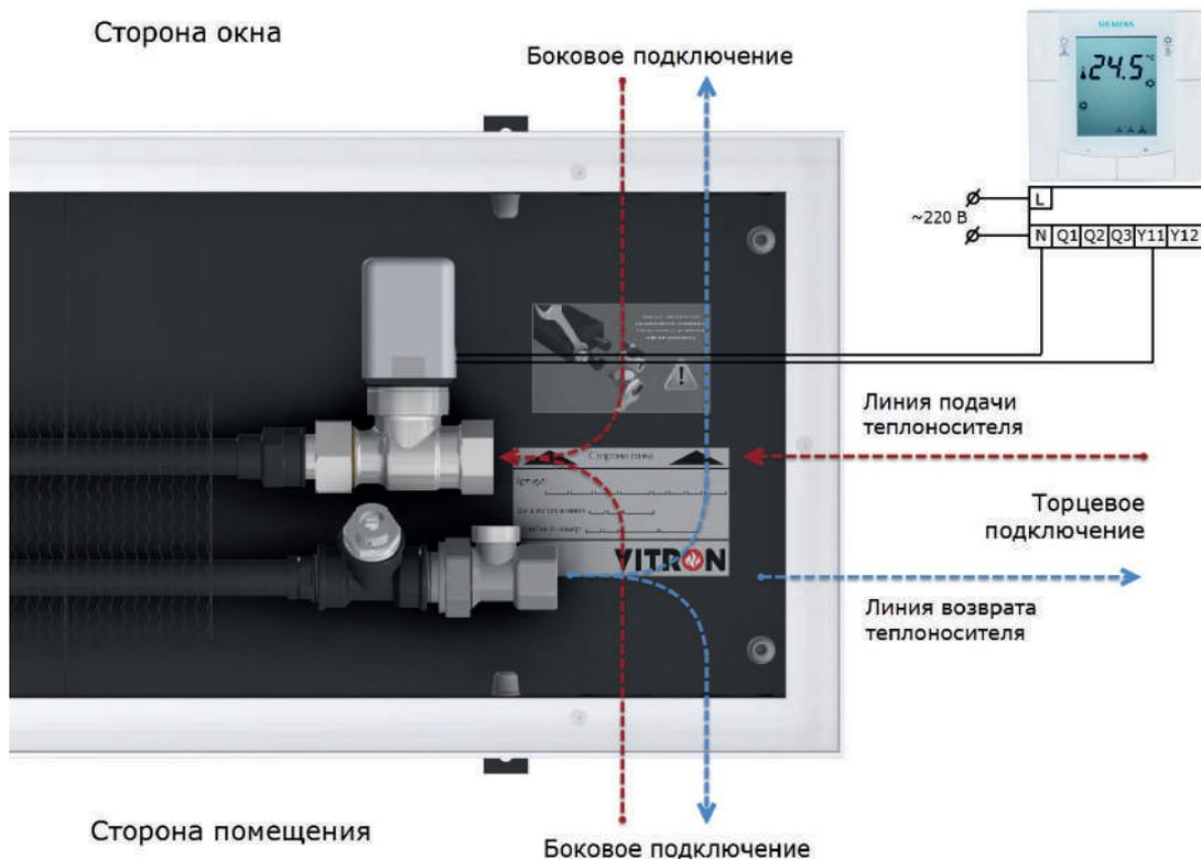
Схема «D» - подающий трубопровод соединить с теплообменником через шаровой кран. Обратный трубопровод соединить с теплообменником через запорно-регулирующий клапан.
