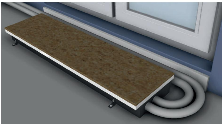
11. Залить бетоном зазоры между стенками отопительного канала и корпусом конвектора;
