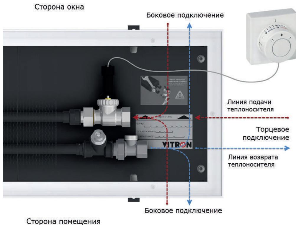
Схема «С» - Подающий трубопровод соединить с теплообменником через термостатический клапан. Обратный трубопровод соединить с теплообменником через запорно-регулирующий клапан. На термостатический клапан установить термоэлектрический двухпозиционный сервопривод;
